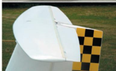
**Ensemble innovant:** une profondeur de forme elliptique et stabilisateur mobile actionné par la commande des volets; sur les photos sont visibles les différentes positions de la commande et du stabilisateur.
